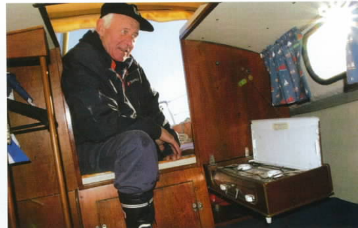
PRAKTISK: Sprit-kokeapparatet er festet til skottet og slås ned over køya ved bruk.
